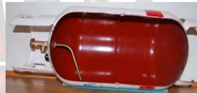
BUTLA wewnątrz (przekrój)
